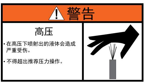
当所有排放或排水管路关闭时,不要进行操作。否则将产生高压,损坏泡沫系统及其组件。
