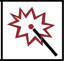
避免损坏控制箱中的电子组件。在跨接启动、焊接、等离子切割或在对设备执行 其他高电压或高强度电流操作时,请断开机架接地。
