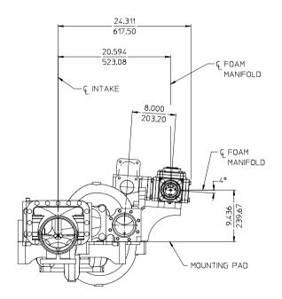
SEPARATELY MOUNTED AQUIS 2.5 FOAM PUMP 500 GPM MANIFOLD, RIGHT HAND DISCHARGE ON THE FRONT OF PUMP WITH 71600-8A PUMP DISCHARGE FITTING
