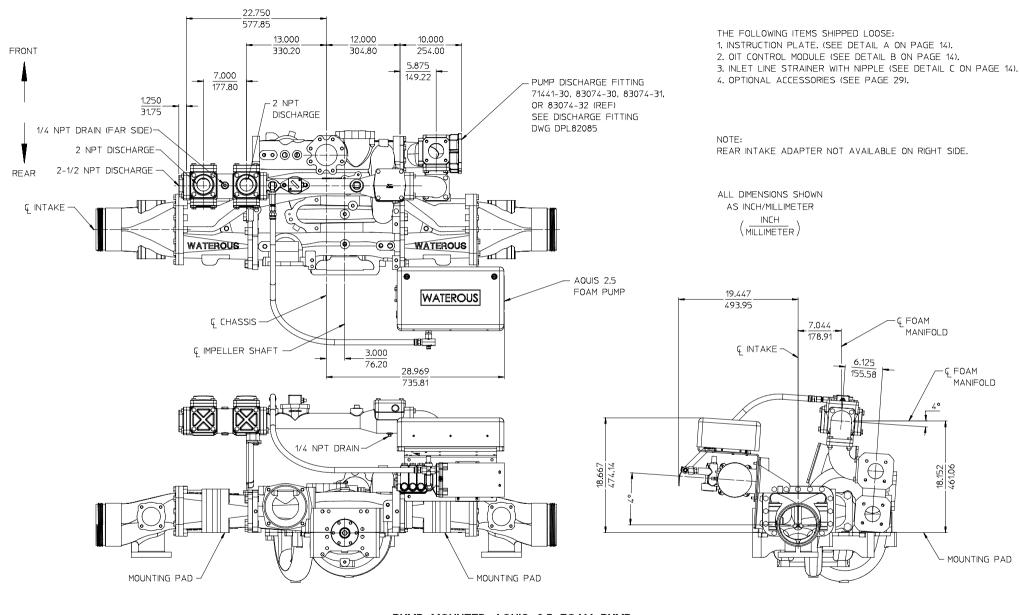
PUMP MOUNTED AQUIS 2.5 FOAM PUMP 500 GPM MANIFOLD, LEFT HAND DISCHARGE OVER THE TOP OF PUMP WITH 71441-30, 83074-30, 83074-31, OR 83074-32 PUMP DISCHARGE FITTING
