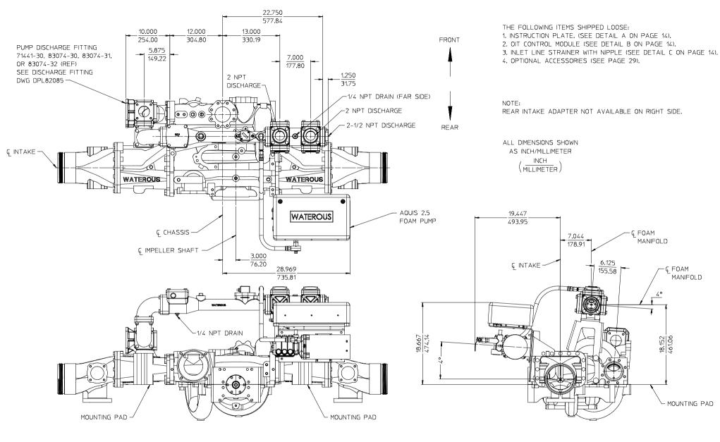
PUMP MOUNTED AQUIS 2.5 FOAM PUMP 500 GPM MANIFOLD, RIGHT HAND DISCHARGE OVER THE TOP OF PUMP WITH 71441-30, 83074-30, 83074-31, OR 83074-32 PUMP DISCHARGE FITTING
