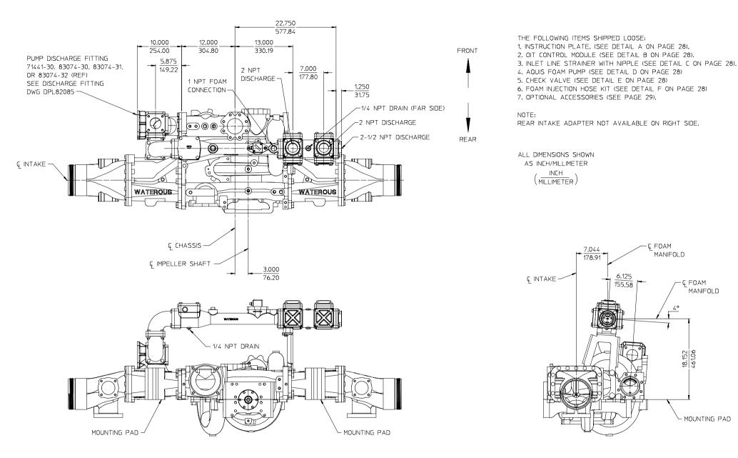
SEPARATELY MOUNTED AQUIS 2.5 FOAM PUMP 500 GPM MANIFOLD, RIGHT HAND DISCHARGE OVER THE TOP OF PUMP WITH 71441-30, 83074-30, 83074-31, OR 83074-32 PUMP DISCHARGE FITTING
