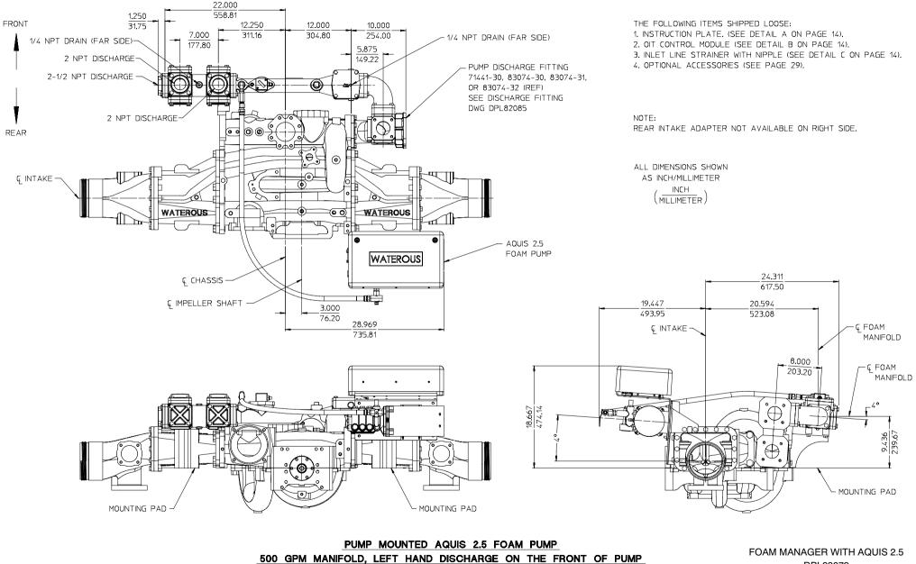
WITH 71441-30, 83074-30, 83074-31, OR 83074-32 PUMP DISCHARGE FITTING
