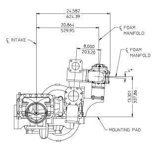
SEPARATELY MOUNTED AQUIS 2.5 FOAM PUMP 500 GPM MANIFOLD, LEFT HAND DISCHARGE ON THE FRONT OF PUMP WITH 81388-7A PUMP DISCHARGE FITTING
