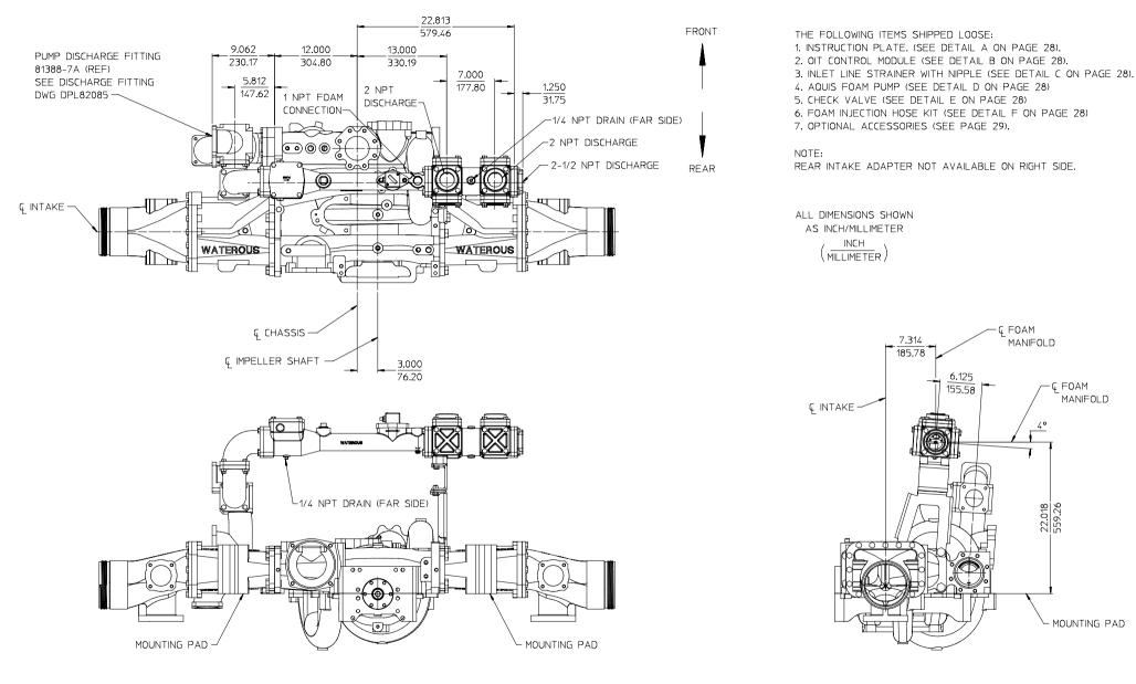
SEPARATELY MOUNTED AQUIS 2.5 FOAM PUMP 500 GPM MANIFOLD, RIGHT HAND DISCHARGE OVER THE TOP OF PUMP WITH 81388-7A PUMP DISCHARGE FITTING
